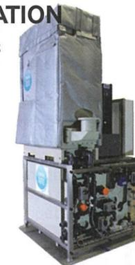
Le nouveau module P2049, avec son skid hydraulique intégré, est capable de concentrer 500 litres par jour de déchets liquides.
