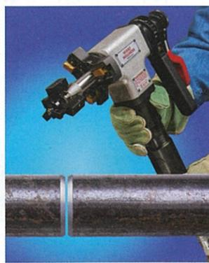
Son triple porte-lames permet de chanfreiner, surfacer et aléser simultanément suivant tout angle sans fluide d'usinage pour la préparation des extrémités.
