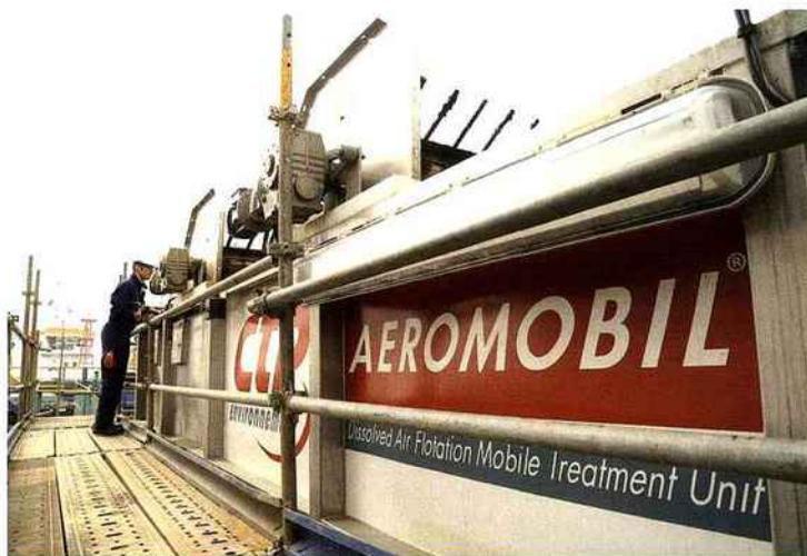
Fruit de deux années d'études et de recherches, l'unité Aeromobil de CTP Environnement est une station de traitement physico-chimique innovante et intégrée de flottation à air dissous capable de traiter jusqu'à 1 000 m<sup>3</sup>/h.
